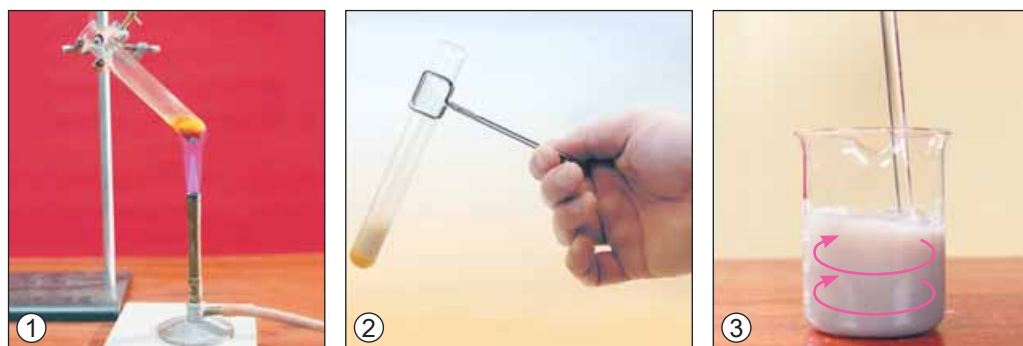
Рис. 3.6. 1. Нагрівання речовини у пробірці, закріпленій у лапці штатива. 2. Використання тримача для пробірок запобігає термічним опікам. 3. Перемішування рідини скляною паличкою
