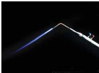
Рис. 23.6. Киснево-ацетиленовий пальник застосовують для зварювання та різання металу. Температура полум'я перевищує 2000 °С. Робота зварювальника потребує зосередженості та обережності
