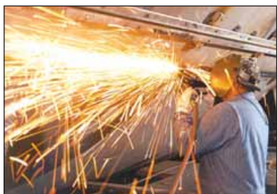
Рис. 21.5. Іскри – частинки залізної ожарини
