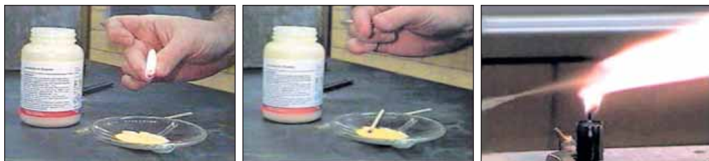
Рис. 22.2. Тонкий жовтий пилок спор плауну (лікоподій) застосовують у фармації для пересипання пігулок. Купку цієї речовини не завжди вдається підпалити сірником. Натомість розпорошений у повітрі лікоподій спалахує миттєво
