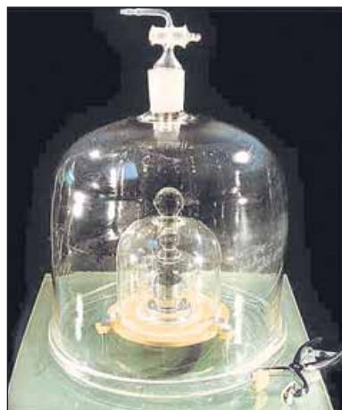
Рис. 10. 1. Кілограм дорівнює масі міжнародного прототипу, який зберігають у Міжнародному бюро мір і ваги у Севрі, поблизу Парижа. Прототип кілограма – циліндричну гирю – виготовлено з платино-іридієвого сплаву (90 % Pt, 10 % Ir)
