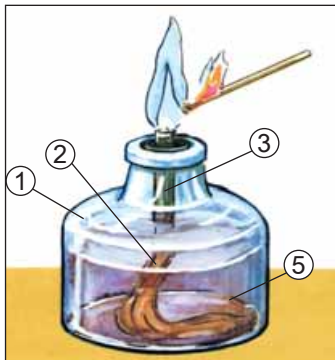
Рис. 4. Будова полум'я: 1 – темна зона, найхолодніша; 2 – найяскравіша частина полум'я, її температура вища, ніж у темній зоні; 3 – верхня частина полум'я, найвища температура
