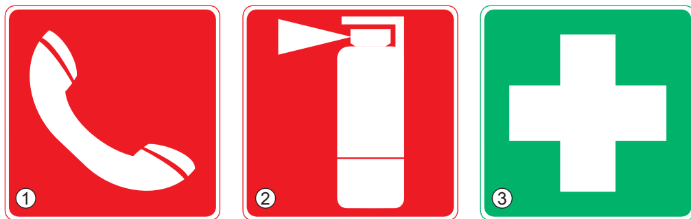
Рис. 3.2. Так позначають розташування різних об'єктів і пристроїв – телефону для сповіщення про пожежу (1), вогнегасника (2), аптечки (3)
