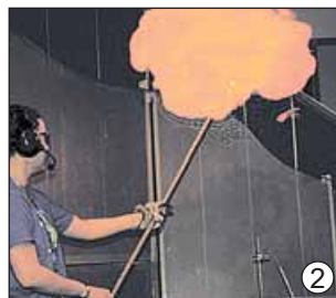
Рис. 18.1. Синтез води (слово «синтез» походить від грец. σύνθεσις – сполучення, складання й означає «з'єднувати», «сполучати»). 1. Опис реакції між киснем і воднем на молекулярному рівні. 2. Зовнішній ефект вибуху воднево-кисневої суміші
