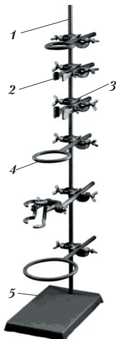
Рис. 19. Будова лабораторного штатива:
